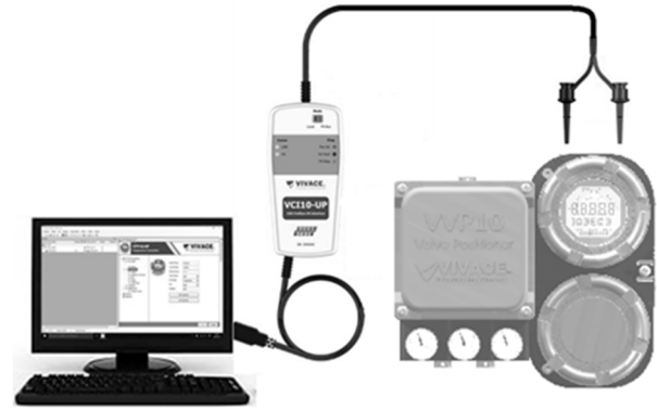
Figura 3.4 - Ligação da VCI10-UP ao VVP10 PROFIBUS.
