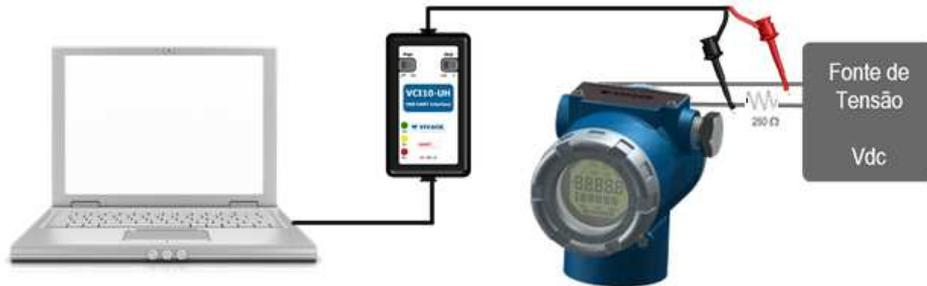
Figura 3.5 - Esquema de ligação da interface VCI10-UH ao VTT10-FH com alimentação externa
