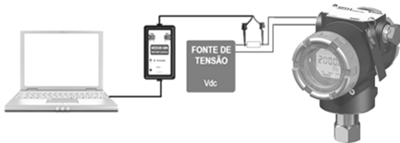
Figura 3.4 - Esquema de ligação da interface VCI10-UH ao VPT11 HART com alimentação externa.
