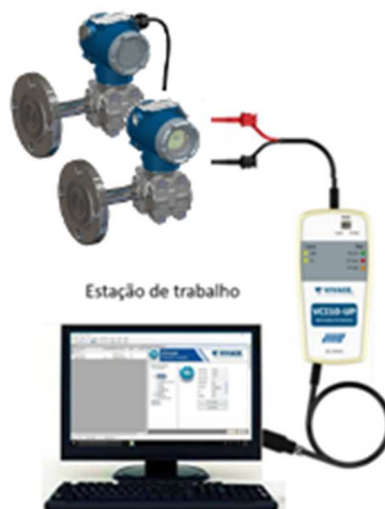
Figura 3.4 – Esquema de configuração do VDL10-P com a VCI10-UP.
