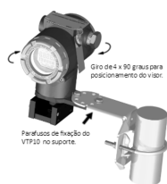
Figura 3 – Ajuste da posição da carcaça.
