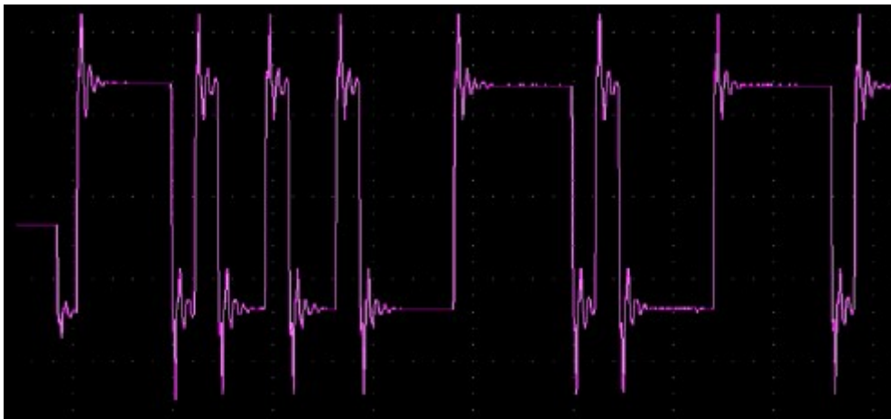
Figura 6 – Sinal Profibus-DP com reflexões.
