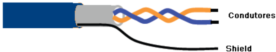
Figura 3 - Cabo de par trançados – PROFIBUS-PA
