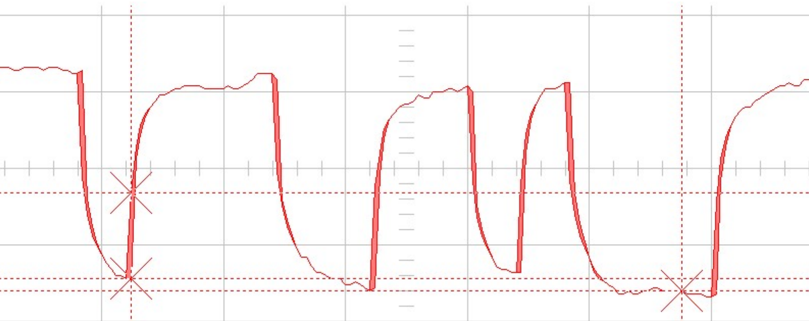
Figura 7 - Efeito capacitivo em um segmento pelo excesso de cabo e spurs .
