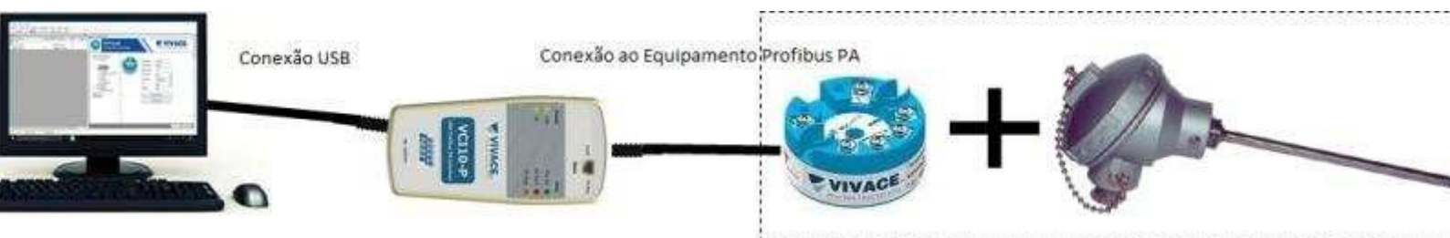
Figura 4: Esquemático de interconexão para o modo de operação “Local”.
