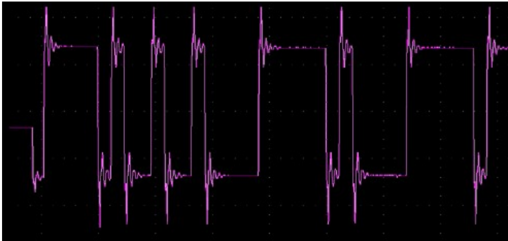
Figura 5 – Sinal Profibus-DP com reflexões.
