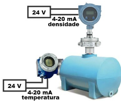
Figura 1 - Aplicação com dois transmissores.
